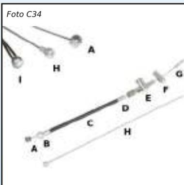
Cavi freno e parti di fissaggio
