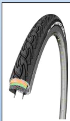
Il copertone **Cheng Shin VN Master Alpha Protect** con protezione antiforatura PlatinumShield combina i vantaggi di uno strato di gomma LDP da 3 mm con uno strato di polifibra EPS a trama fitta e leggerissima. Questa struttura multistrato offre una protezione ottimale contro le forature. Ha un profilo scorrevole e confortevole ed è facile da installare grazie alla mancanza di un montaggio direzionale.
