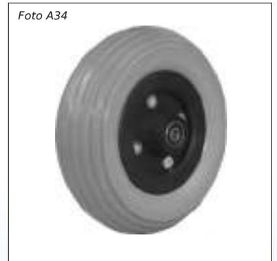
Ruota in PU 7", 178 x 56 mm
