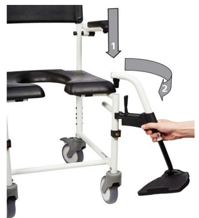
Abb. 3: Montage der Fußstütze
